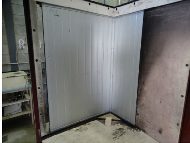
Foto 6 – Disposição do material no carrinho de ensaio.
